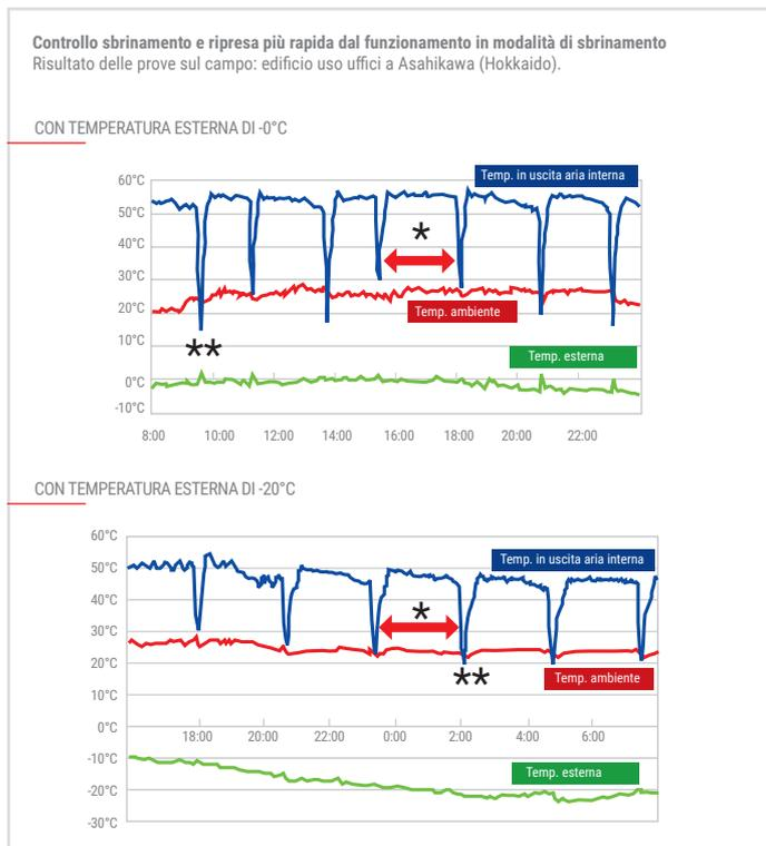
\* Con il Controllo Sbrinamento di ZUBADAN, l'intervallo massimo tra due operazioni di sbrinamento è stato di 150 minuti con temperature esterne di circa -20°C o 0°C.
